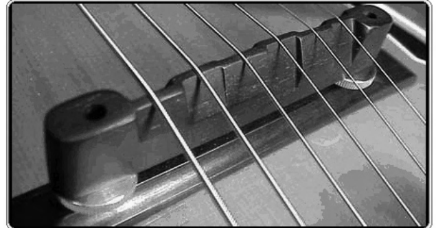
Figura 5: Puente móvil con compensación individualizada, en guitarra, y de altura ajustable
