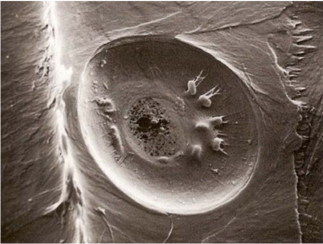
(Serie de fotografías de microscopio electrónico de barrido en que se aprecia cómo las bacterias van degradando las membranas de las punteaduras hasta dejarlas limpias, con lo cual la madera pierde densidad sin cambiar de manera significativa su rigidez. Karl Roy "The Violon, It's History and Making" 2006
